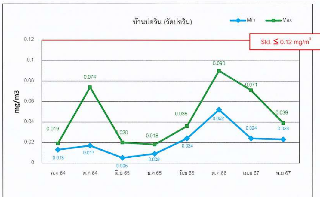
รูปที่ 4.1-1 กราฟเปรียบเทียบผลการตรวจวัดปริมาณฝุ่นละอองขนาดเล็กกว่า 10 ไมครอน (PM 10 ) บ้านบ่อวิน (วัดบ่อวิน) ปี พ.ศ. 2564-2567
