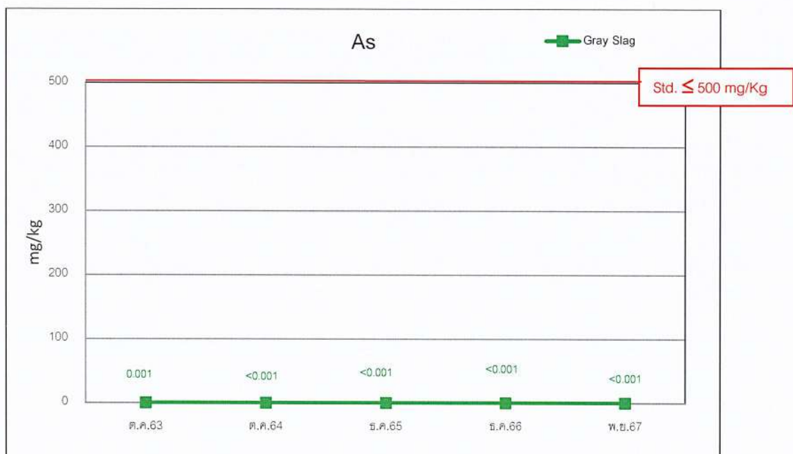
รูปที่ 4.5-10 กราฟเปรียบเทียบผลการตรวจวัด Arsenic ในกากของเสียบริเวณ Gray Slag ปี พ.ศ. 2563-2567
