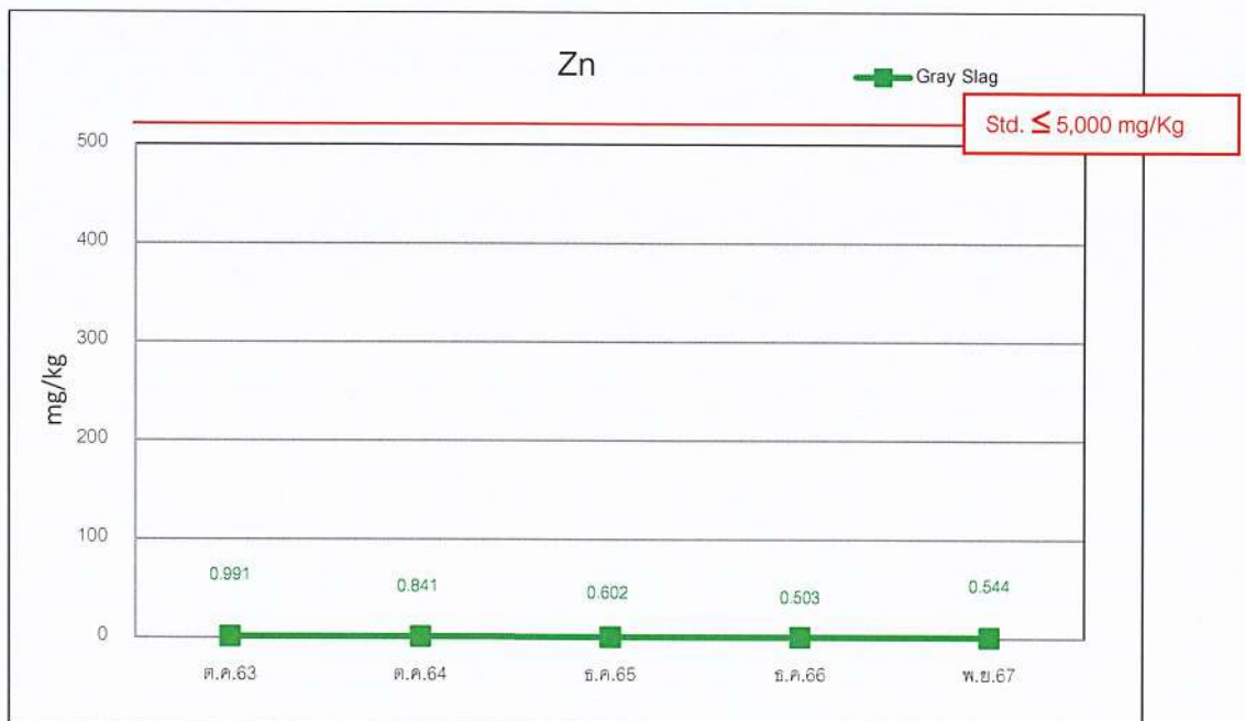
รูปที่ 4.5-14 กราฟเปรียบเทียบผลการตรวจวัด Zinc ในกากของเสียบริเวณ Gray Slag ปี พ.ศ. 2563-2567
