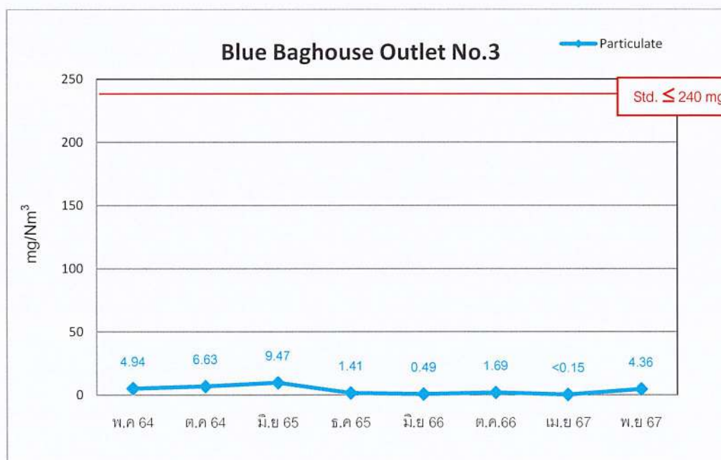
รูปที่ 4.3-4 กราฟเปรียบเทียบผลการตรวจวัดปริมาณ TSP ในอากาศที่ระบายออกจากปล่อง Blue Baghouse Outlet No.3 ปี พ.ศ. 2564-2567
