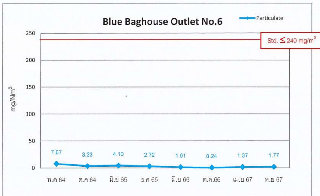
รูปที่ 4.3-7 กราฟเปรียบเทียบผลการตรวจวัดปริมาณ TSP ในอากาศที่ระบายออกจากปล่อง Blue Baghouse Outlet No.6 ปี พ.ศ. 2564-2567
