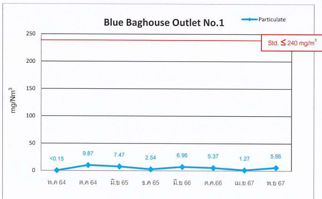
รูปที่ 4.3-2 กราฟเปรียบเทียบผลการตรวจวัดปริมาณ TSP ในอากาศที่ระบายออกจากปล่อง Blue Baghouse Outlet No.1 ปี พ.ศ. 2564-2567
