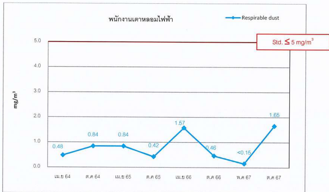
รูปที่ 4.6-1 กราฟเปรียบเทียบผลการตรวจวัดฝุ่นละอองในบรรยากาศการทำงาน พนักงานเตาหลอมไฟฟ้า ปี พ.ศ. 2564-2567
