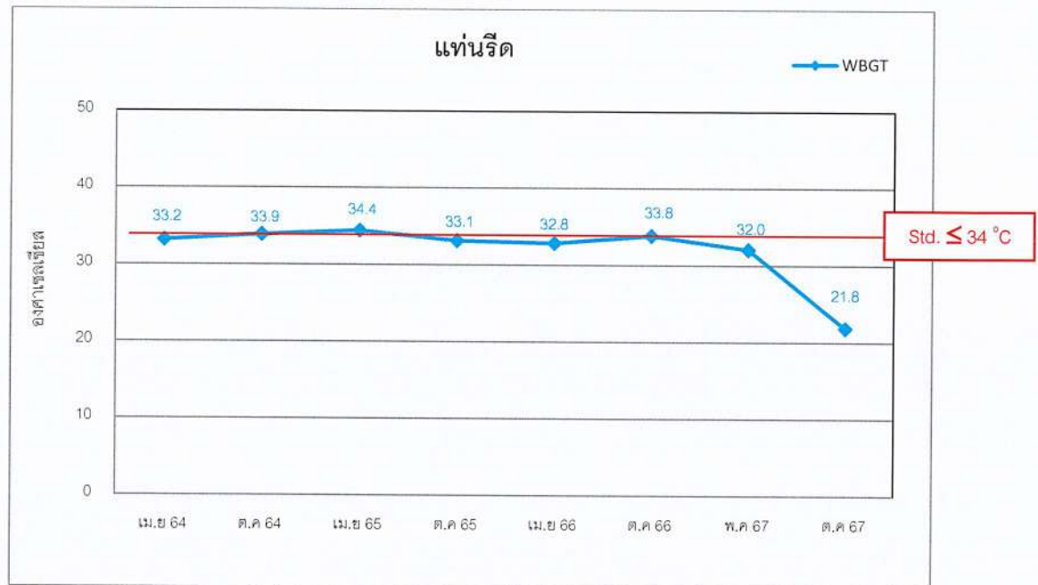
รูปที่ 4.8-2 กราฟเปรียบเทียบผลการตรวจวัดสภาพความร้อน บริเวณแท่นรีด ปี พ.ศ. 2564-2567
