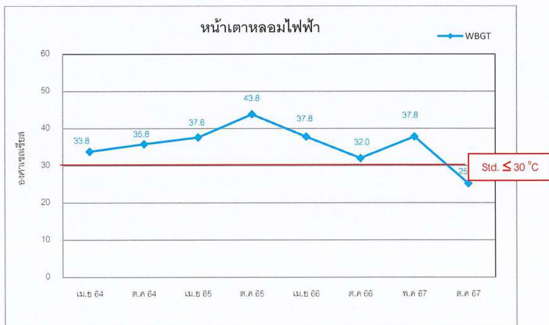
รูปที่ 4.8-1 กราฟเปรียบเทียบผลการตรวจวัดสภาพความร้อน บริเวณเตาหลอมไฟฟ้า ปี พ.ศ. 2564-2567
